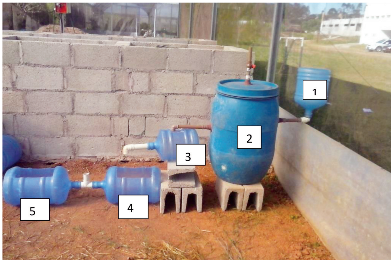
Figura 1. Sistema experimental de tratamento de resíduos sólidos de hortaliças
