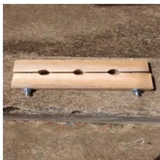
Figura 9: Suporte para suspensão das mangueiras (Fonte: Autoria própria)
