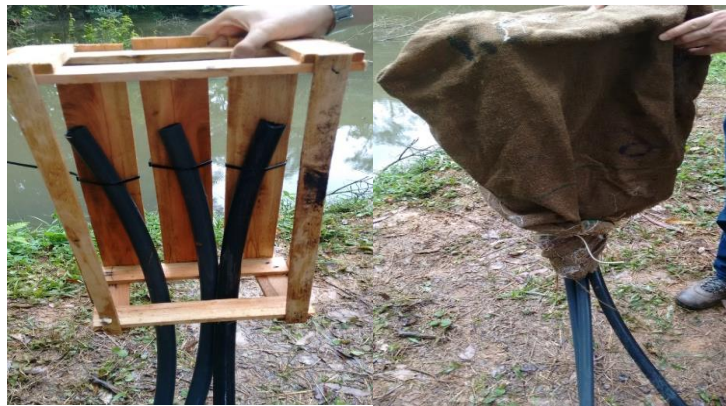
Figura 8: Caixa de madeira para fixação das mangueiras (esquerda) Saco de juta para filtragem (direita) (Fonte: Autoria própria)
