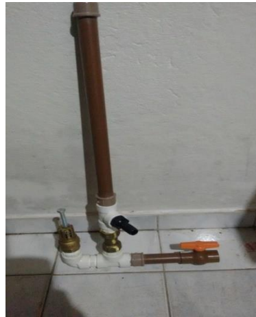
Figura 4: Carneiro hidráulico de PVC (Fonte: Autorial própria)
