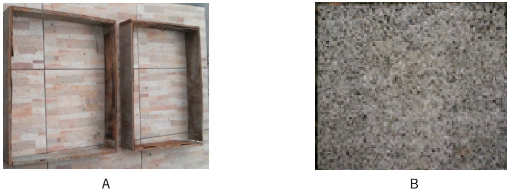
Figura 1 – A - Molduras de madeira utilizadas para a construção dos blocos. B - Bloco de cimento poroso finalizado.
