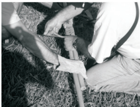
Figura 1. Operação de alongamento do bastão do prisma com auxílio de tiras de borracha e varas de bambu de 2,5 m.
