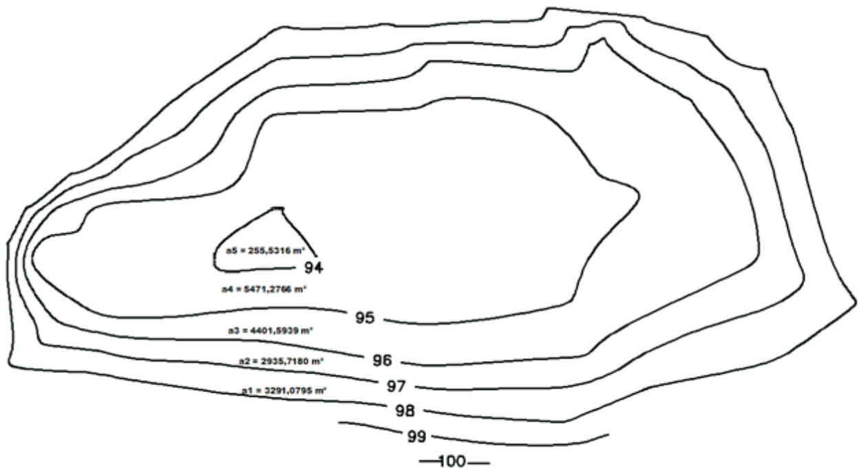
Figura 10. Curvas batimétricas do lago com visível interface entre espelho d'água e a margem, mostrando ainda as sub-áreas entre curvas utilizadas para o cálculo do volume, bem como os índices das curvas de nível, conforme fórmula da página anterior.
