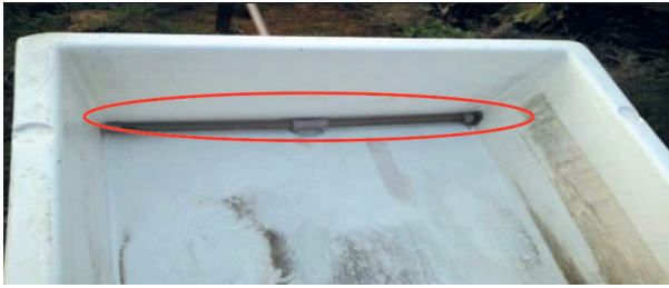
Figura 2a. Tubulação perfurada pré-filtro para coleta do resíduo pré-filtrado. Fonte: Elaboração própria.
